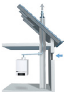
Nasávání spalovacího vzduchu z místnosti instalace.
