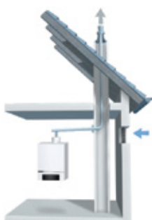
Nasávání spalovacího vzduchu z místnosti instalace.
