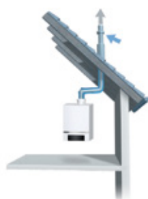
Nasávání spalovacího vzduchu z venkovního prostoru.
