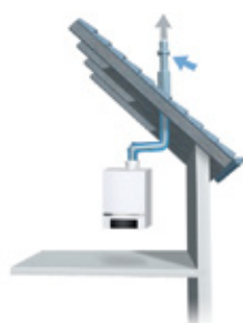
Nasávání spalovacího vzduchu z venkovního prostoru.
