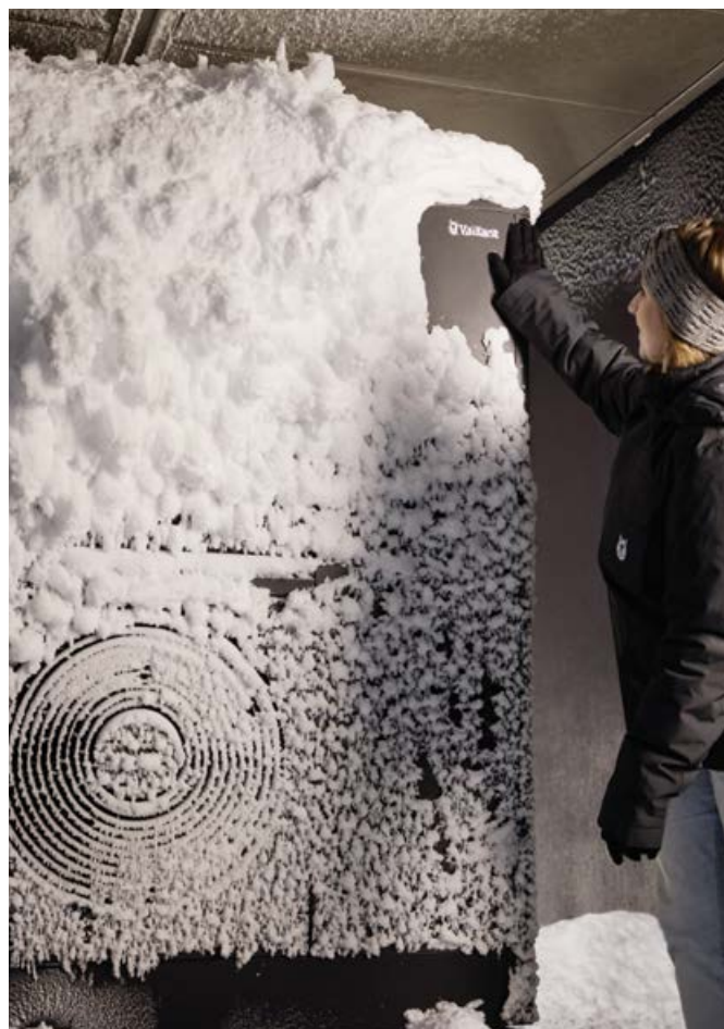
Klimatická komora pro simulaci různých ročních období
